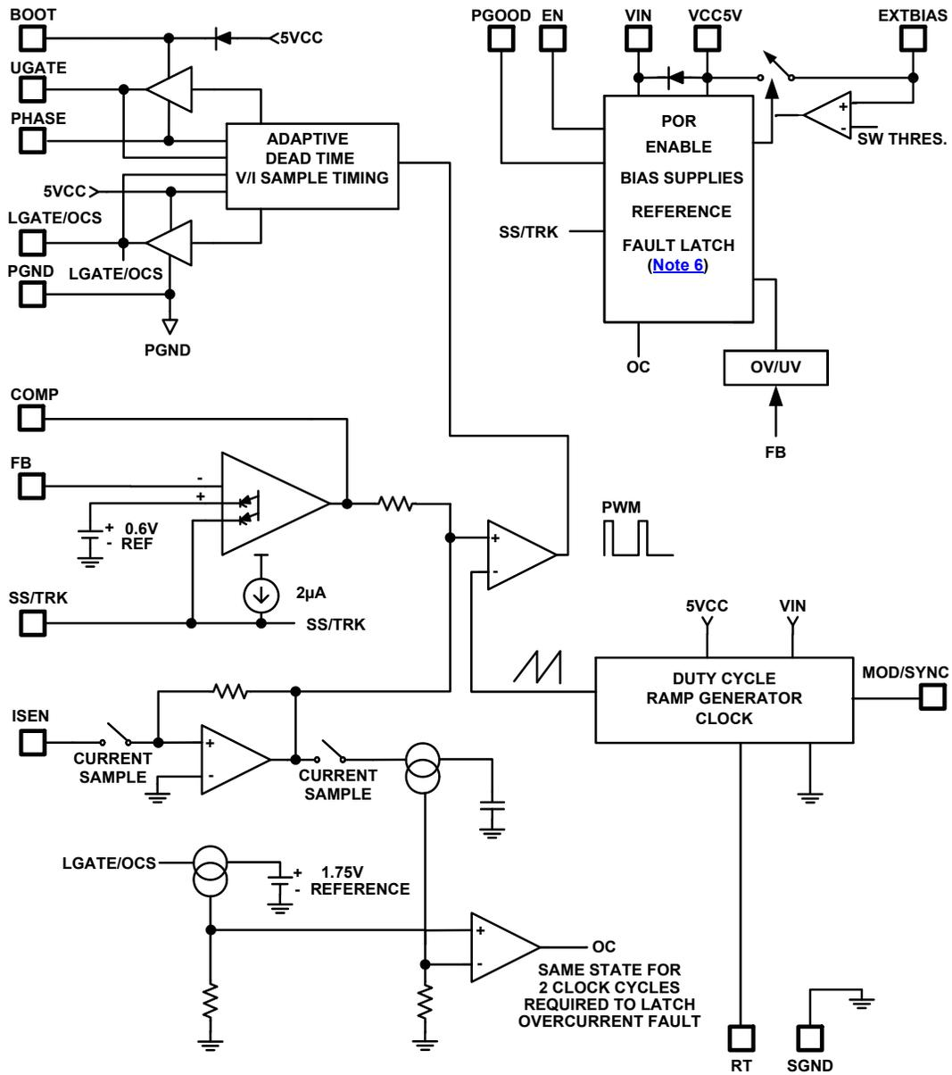
FIGURE 3. BLOCK DIAGRAM
